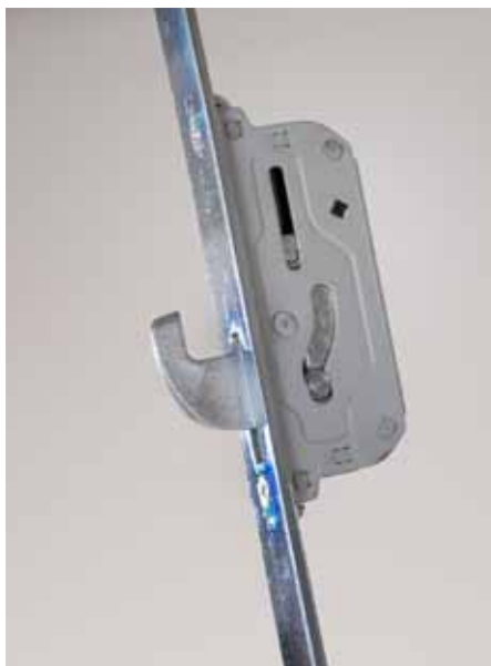
Afb. 15 De haakschoten moeten naar boven wijzen
