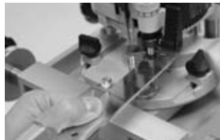
Afb. 21 Voorplaat tussen blokkering en diepte-aanslag
