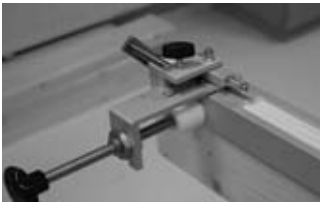
Afb. 1 Aanslagpoot tegen onderzijde deur
