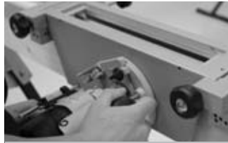
Afb. 15 Uitfrezen kruk gat en cilindergat.
