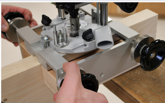
Afb.4 Plaatsen en afstellen Freesmachine
