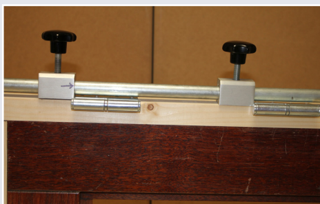
Afb. 6 Aanslag tegen bovenzijde Scharnierblad
