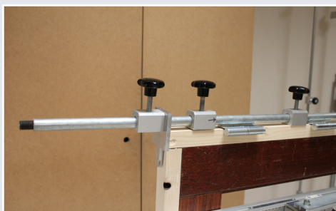
Afb. 5 Bovenplaat (T-vorm) bovenzijde raam
