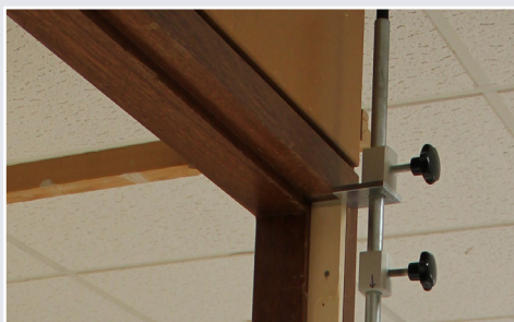
Afb. 9 Raamtelescoop gepositioneerd in het kozijn
