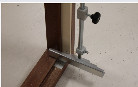
Afb. 8 Raamtelescoop uit blokkeerstand
