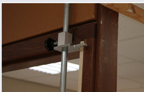
Afb. 2 Raamtelescoop gepositioneerd in kozijn
