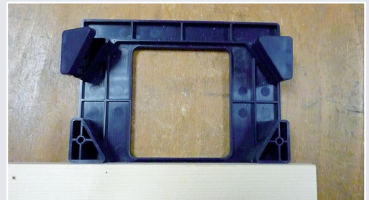
Afb. 4 Vulblokjes plaatsen in Scharniermal
