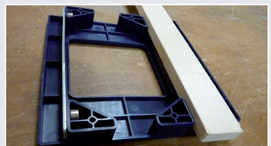
Afb. 8 - 5 à 6 mm strip tegen Scharniermal (incl. houten lat)
