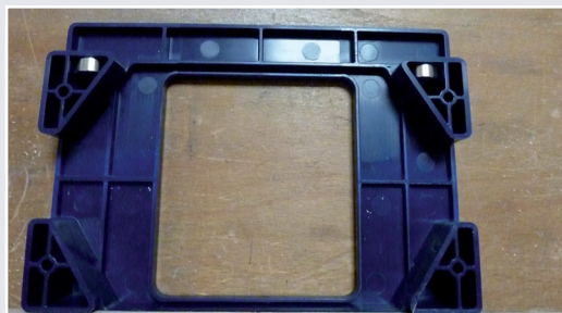
Afb. 5 Magnetten geplaatst in hoek Scharniermal.
