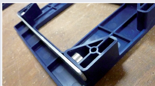
Afb. 7 - 5 à 6 mm strip tegen Scharniermal
