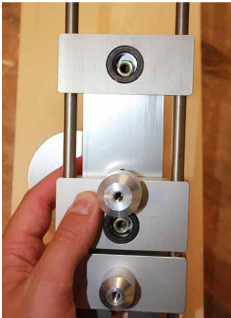
Afb. 7 Veiligheidsnokken tegen onderzijde
