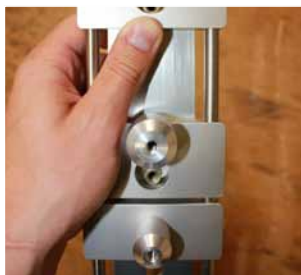
Afb. 6 Veiligheidsnokken tegen onderzijde boorbussen
