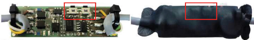
Afb. 1 Geïntegreerde besturing (buitenste knop = delete knop, binnenste knop = pairing knop)
